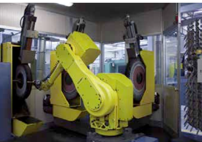
Robot per lucidatura e brillantatura delle maniglie nella fabbrica Olivari a Borgomanero (2010). Robotized polishing and buffing operations in the Olivari factory in Borgomanero (2010).
