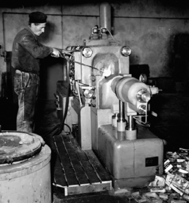
Lavorazione di pressofusione di ottone nelle officine Olivari a Borgomanero negli anni cinquanta. Die-casting brass in the Olivari production shops in Borgomanero, 1950s.
